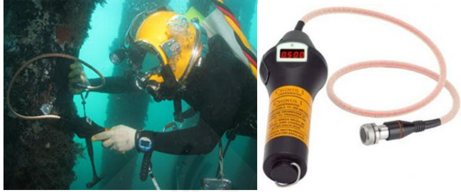
الشكل (12-6) اختبار السماكة باستخدام الموجات الصوتية
