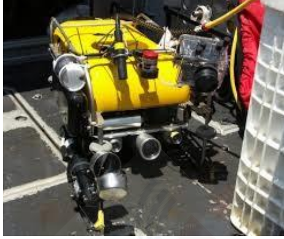
المركبات المتحكم بها عن بعد المزودة بكاميرات للقيام بالتصوير
